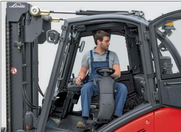
Mit einem einfachen Handgriff wird der gesamte Arbeitsplatz inklusive Sitz, Bedieneinheit, Lenkrad und Pedale in die gewünschte Position gebracht. Durch leichtes Kopfbewegen hat der Fahrer so immer einen optimalen Blick in Fahrtrichtung – auch bei Rückwärtsfahrten.
